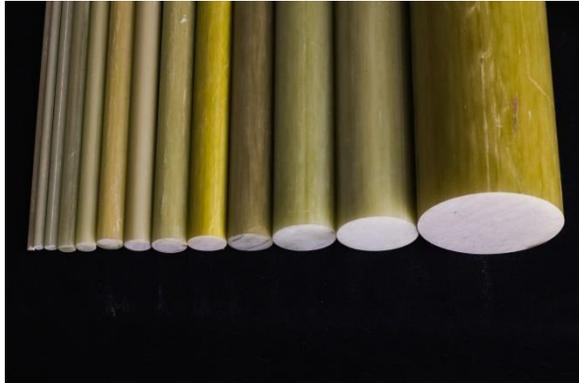
**Стержни цилиндрические однонаправленные «ПУЛГЛАСС»** изготавливают методом непрерывной протяжки через формирующую фильеру ровинга из стеклянных нитей.
