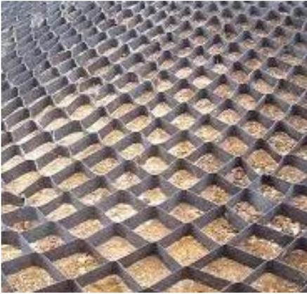
Геосоты «АРМОСЕЛЛ» - геосинтетический материал, образованный из геополос, расположенных и скрепленных в перпендикулярных плоскостях.
