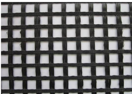
Геосетки «Нефтегаз ГРУНТСЕТ» представляют собой сетки стеклянные, образованные из двух систем ровингов, расположенных перпендикулярно по отношению друг к другу, провязанных между собой третьей – провязывающей нитью – и пропитанные полимерными связующими.
