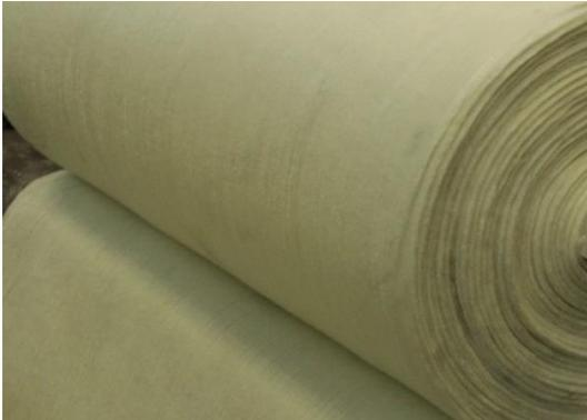
Полотна иглопробивные стеклянные типа ИПС-Т представляют собой стеклохолст, сформированный аэродинамическим способом, волокна которого скреплены многократным иглопрокачиванием.
