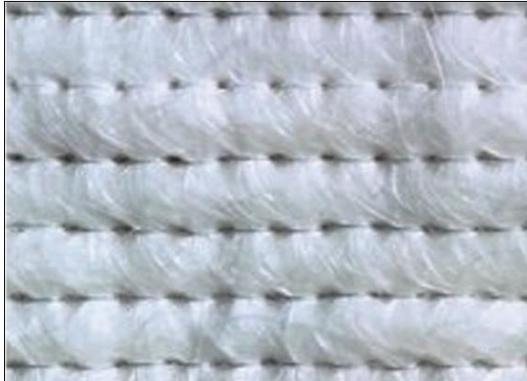
Полотна стекловолокнистые холстопрошивные типа ПСХ-Т представляют собой многослойный холст, скрепленный вязально-прошивным способом переплетением «цепочка» или «трико». Полотна марки ПСХ-Т предназначены для целей теплоизоляции.
